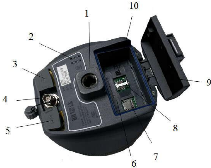
1-连接螺孔 2-喇叭 3-USB 接口及防护塞 4-GPRS/电台/天线接口 5-五芯插座及防护塞 6-电池仓 7-SD 卡槽 8-SIM 卡槽 9-电池盖 10-弹针电源座
